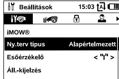
A „Beállítások” és az „Információ” almenük fülek formájában jelennek meg. A fülek a bal, illetve a jobb oldali irányítógombok megnyomásával választhatók ki, az almenük kiválasztása pedig a lefelé, illetve felfelé mutató irányítógombokkal történik. Az aktív fülek, illetve menüpontok háttere fekete.
