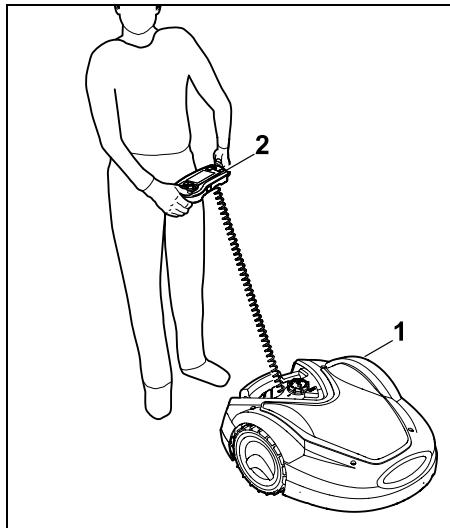
Роботом-газонокосилкой (1) можно скашивать газон также вручную, как и обычной газонокосилкой. Для этого следует вынуть пульт управления (2), выбрать в меню «Подробнее» опцию «Кошение вручную», активировать нож косилки, а также привод движения и идти сзади за роботом-газонокосилкой. (⇒ 15.6)
