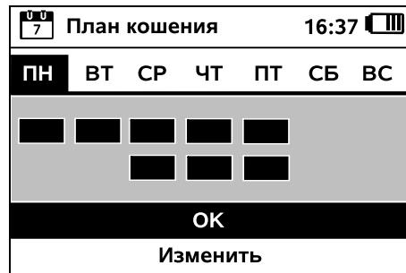
Нажатием на OK подтверждается отображаемый план кошения, после чего открывается последний этап Мастера установки.
