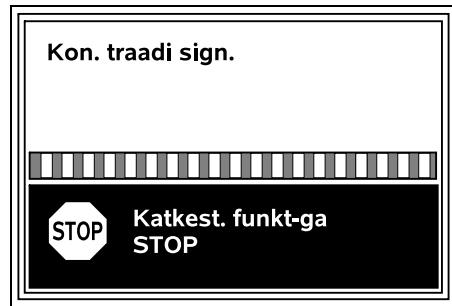
Traadi signaali kontrollimine võib kesta mitu minutit. Kui vajutate punast nuppu STOP seadme peal, ühendamine katkeb ja avaneb paigaldusabilise eelmine samm.
